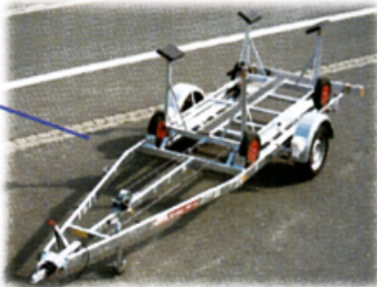
Typ 140 S für „Dyas“ mit tiefliegender Kielwanne
