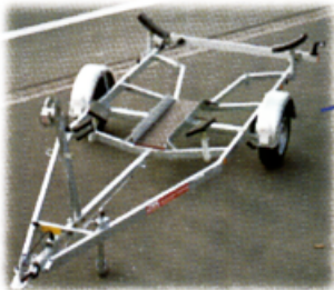
Typ 145 SL mit auffahrbarem Slipwagen
